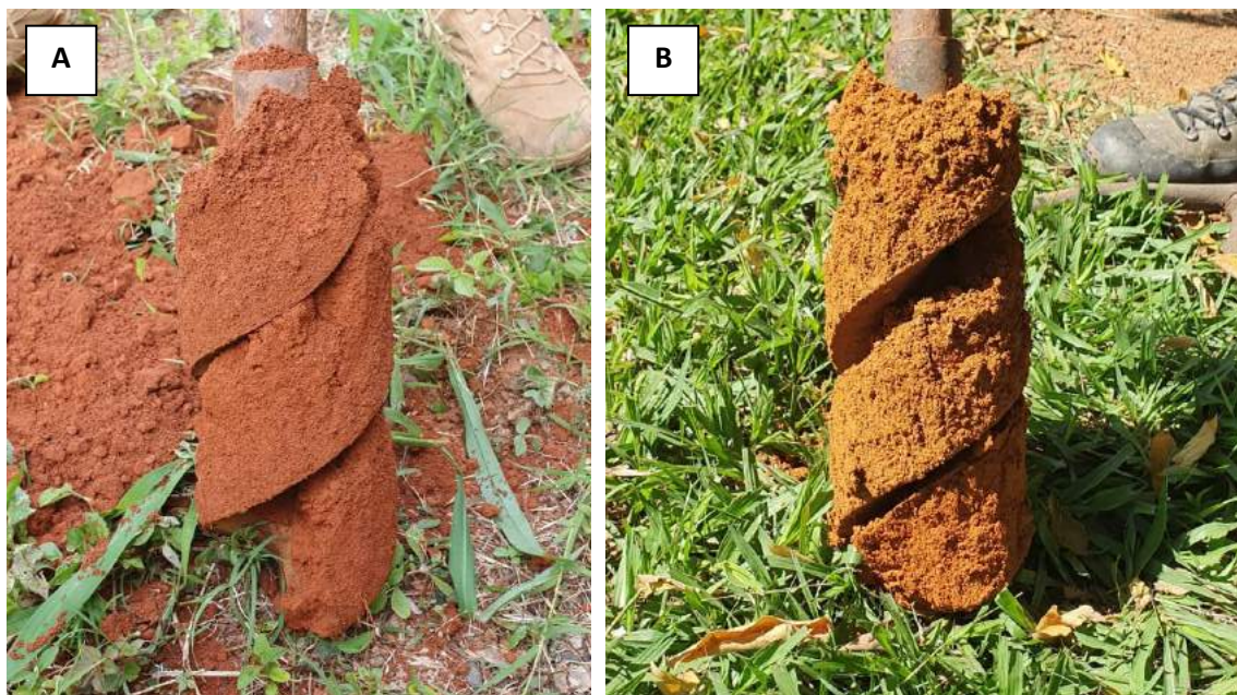
Figura 13 - Materiais obtidos de perfis de latossolos com auxílio de trado manual. Notar a estruturação granular dos materiais (A) Ponto 65 Campanha 1. Latossolo Vermelho e (B) Ponto 23 Campanha 1. Latossolo Vermelho-Amarelo.
