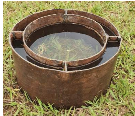
Figura 19 – Ensaio de infiltração in situ com o método dos anéis concêntricos.
