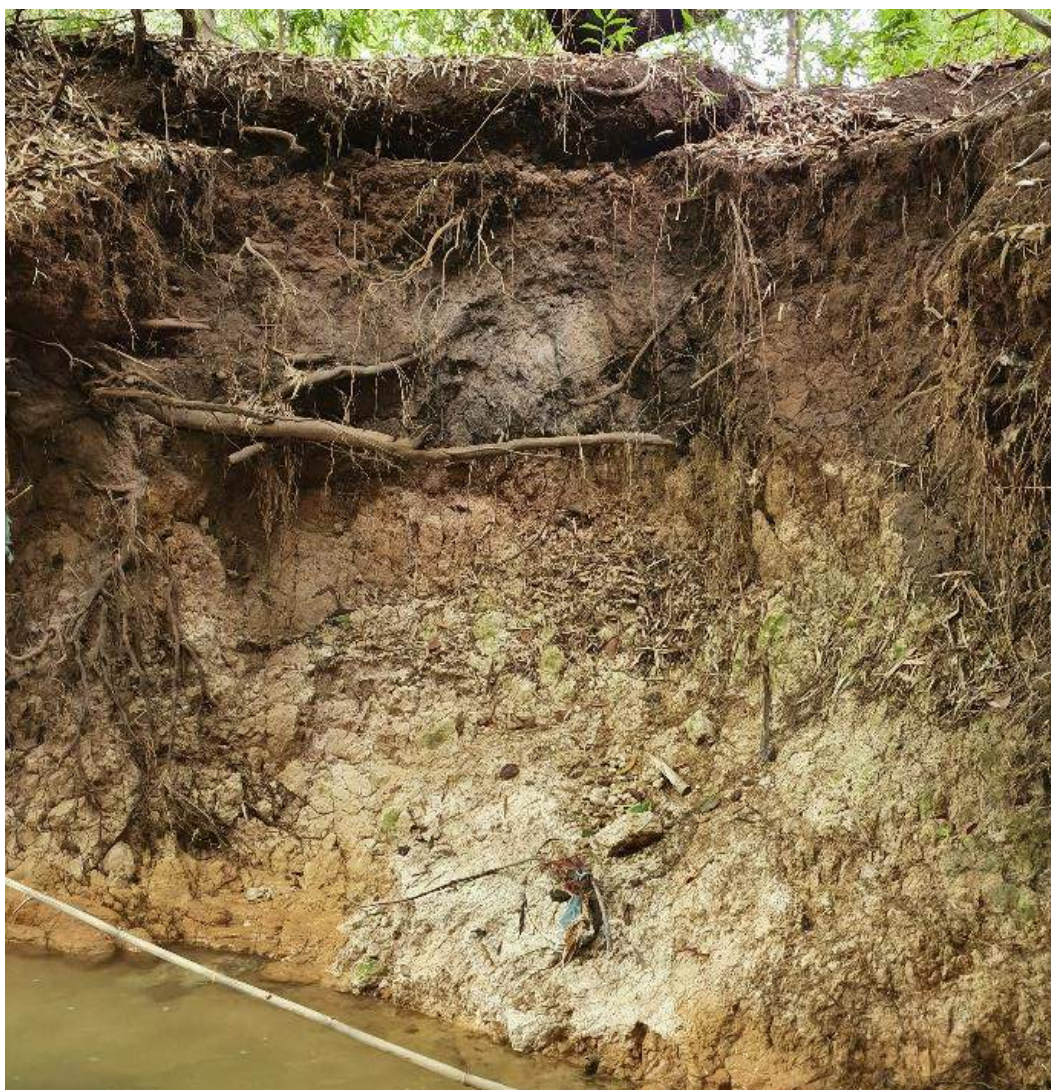
Figura 16 - Ponto 18 Campanha 2. Neossolo Flúvico às margens do Córrego Vereda da Cruz. Pacote de cor bruno amarronzada com espessura variável entre 1,5 e 2,5m sobreposto a horizonte cinza esbranquiçado, interpretado como diagnóstico de paleo Gleissolo.
